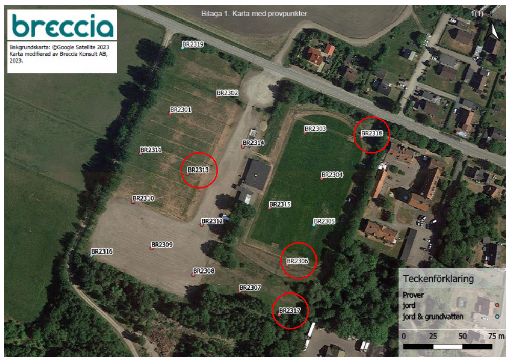
Utdrag från provtagningsplan. Röda ringar markerar de provpunkter där halter över känslig markanvändning har detekterats. Källa: Breccia
