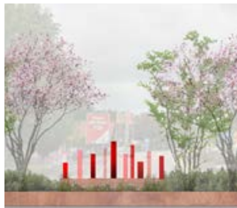
Plexirören har lådor för infästning av strålkastare och plexirör innanför den övre cortenmuren. Plexirör 55 mm opaliserat plexiglas med sluten topp.
